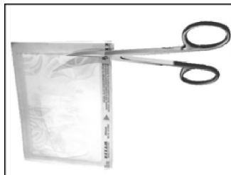
Cortar uma das extremidades da embalagem com tesoura para evitar deformação da membrana.
